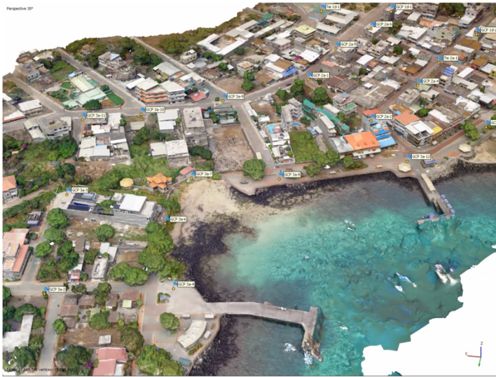
Modelo 3D Topo-Bathy de Puerto Baquerizo Moreno creado con una novedosa técnica de mapeo con drones. Estos modelos son esenciales para la planificación de la resiliencia climática.
